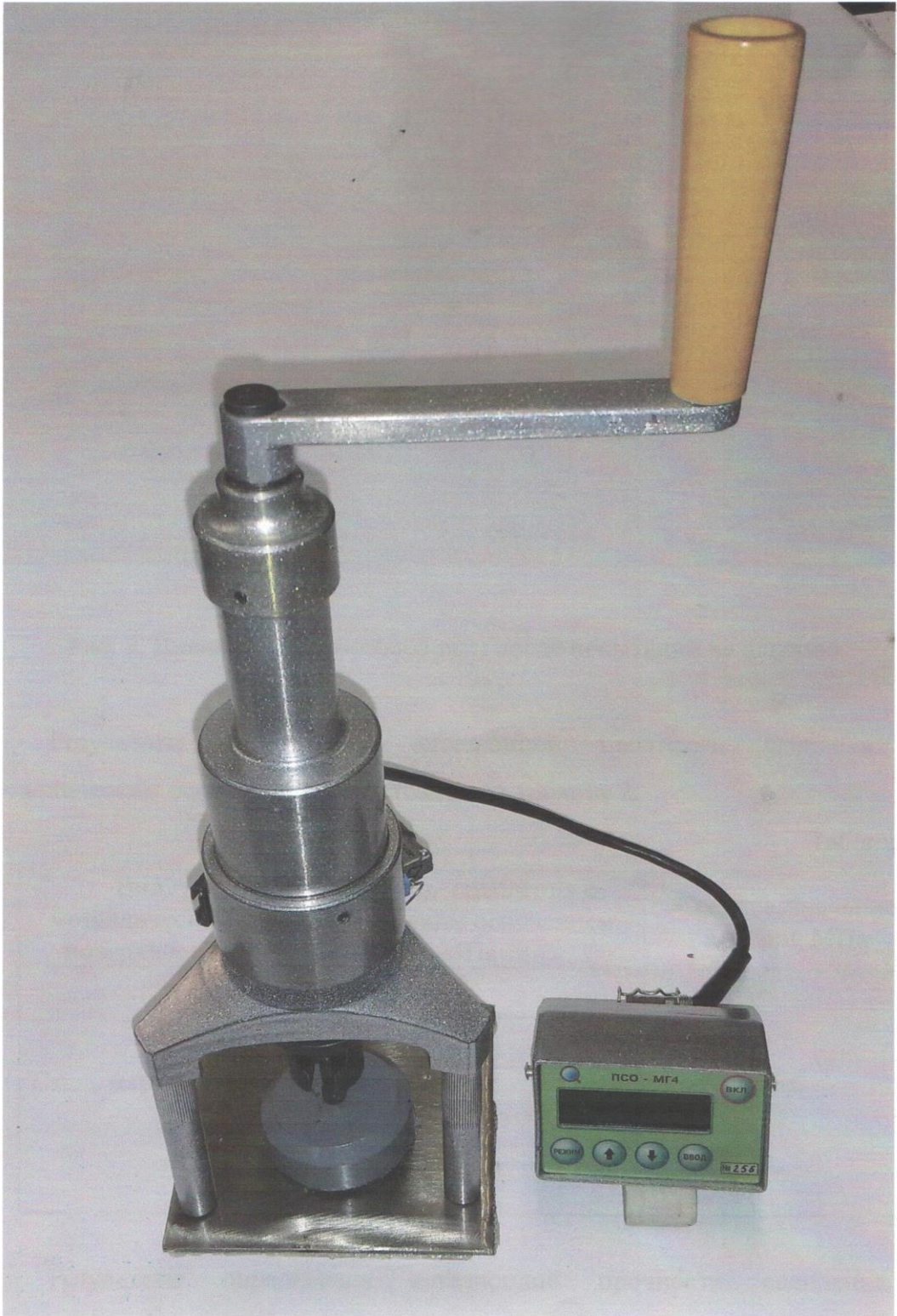
Рис.2. Общий вид измерителя адгезии ПСО – 10МГ4.
