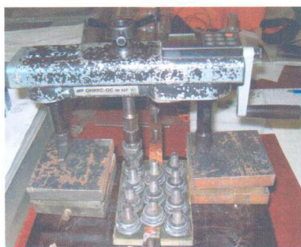
Рисунок 1. Испытание на прочность сцепления образцов системы гидроизоляционного покрытия «Силор-Ультра» с металлическим основанием
