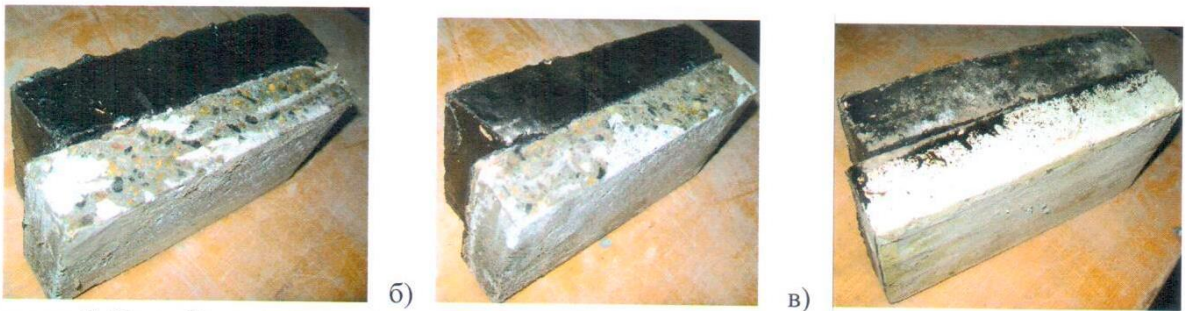
Рисунок. 1. Испытание на прочность сцепления при сдвиге образцов системы гидроизоляционного покрытия «Силор-Ультра» на бетонном основании со слоем из литой асфальтобетонной смеси ЛС тип V
