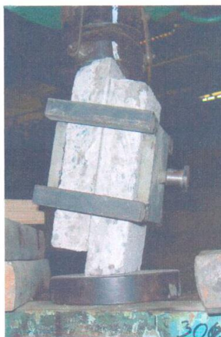
Рисунок 1. Испытание на прочность сцепления при сдвиге образцов системы гидроизоляционного покрытия «Силор-Ультра» с бетонным основанием
