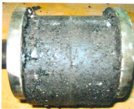
Рисунок 2. Вид пакета из образцов системы гидроизоляционного покрытия «Силор-Ультра» на металлическом основании после сдвига
