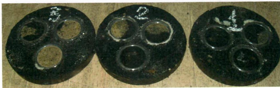
Рисунок. 1. Вид образца системы гидроизоляционного покрытия «Силор-Ультра» на металлическом основании со слоем из мелкозернистой плотной асфальтобетонной смеси тип Б, марки I после отрыва элементов
