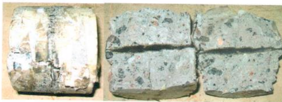
Рисунок 1. Вид образцов системы гидроизоляционного покрытия «Силор-Ультра» на бетонном основании с 3 мм слоем из мелкозернистой плотной асфальтобетонной смеси тип Б, марки I после испытания
