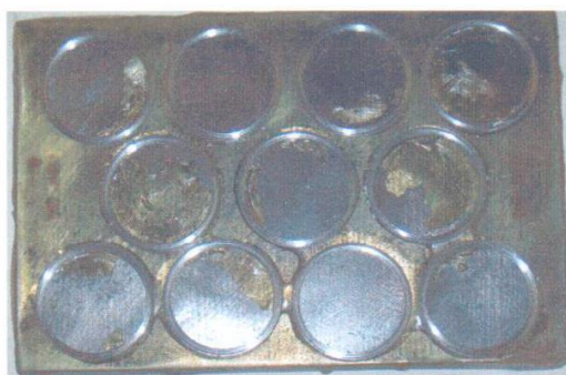
Рисунок 2. Вид образца системы гидроизоляционного покрытия «Силор-Ультра» на металлическом основании после отрыва элементов
