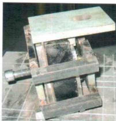
Рисунок 2. Образцов системы гидроизоляционного покрытия «Силор-Ультра» на металлическом основании после сдвига с испытательной оснасткой
