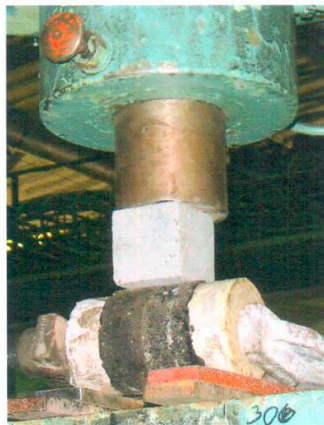
Рисунок 1. Испытание на прочность сцепления при сдвиге образцов системы гидроизоляционного покрытия «Силор-Ультра» на бетонном основании со слоем из мелкозернистой плотной асфальтобетонной смеси тип Б, марки I
