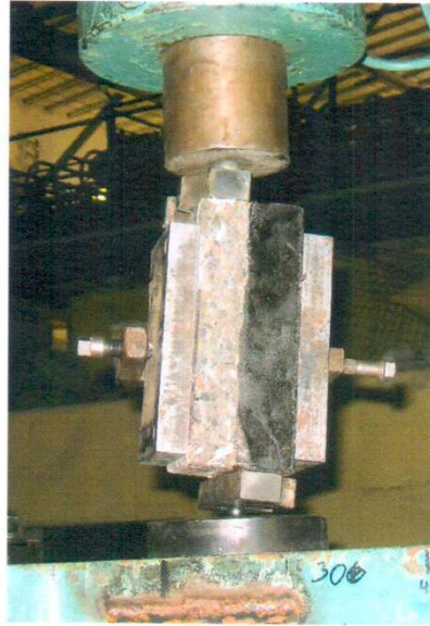
Рисунок. 1. Испытание на прочность сцепления при сдвиге образцов системы гидроизоляционного покрытия «Силор-Ультра» на бетонном основании со слоем из литой асфальтобетонной смеси ЛС тип V
