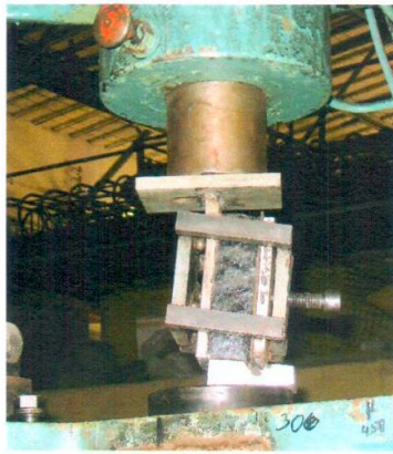
Рисунок 1. Испытание на прочность сцепления при сдвиге образцов системы гидроизоляционного покрытия «Силор-Ультра» с металлическим основанием со слоем из литой асфальтобетонной смеси ЛС тип V
