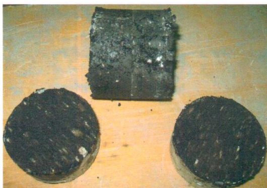
Рисунок 2. Вид образцов системы гидроизоляционного покрытия «Силор-Ультра» на бетонном основании со слоем из мелкозернистой плотной асфальтобетонной смеси тип Б, марки I после сдвига
