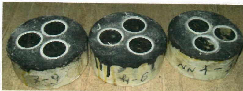
Рисунок. 1. Вид образца системы гидроизоляционного покрытия «Силор-Ультра» на бетонном основании со слоем из мелкозернистой плотной асфальтобетонной смеси тип Б, марки I после отрыва элементов
