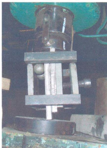
Рисунок 1. Испытание на прочность сцепления при сдвиге образцов системы гидроизоляционного покрытия «Силор-Ультра» с металлическим основанием
