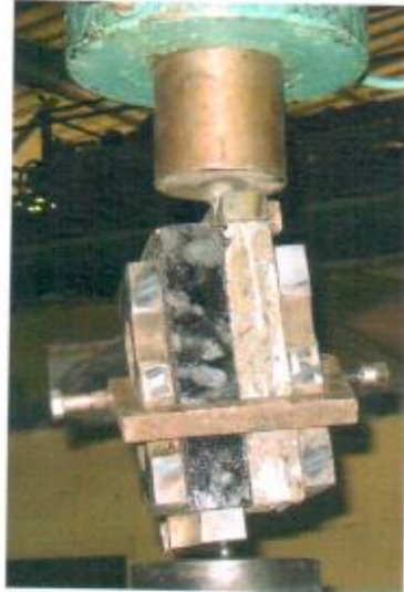
Рисунок. 1. Испытание на прочность сцепления при сдвиге образцов системы гидроизоляционного покрытия «Силор-Ультра» на бетонном основании со слоем из литой асфальтобетонной смеси ЛС тип V
