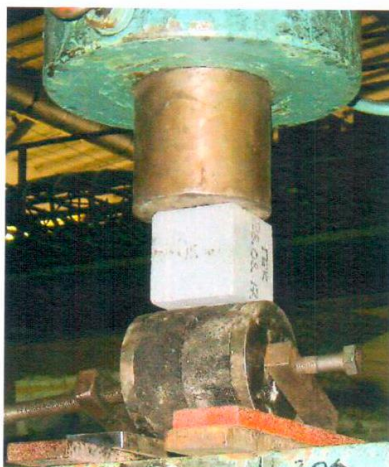
Рисунок 1. Испытание на прочность сцепления при сдвиге образцов системы гидроизоляционного покрытия «Силор-Ультра» с металлическим основанием со слоем из мелкозернистой плотной асфальтобетонной смеси тип Б, марки I
