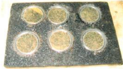
Рисунок. 1. Вид образца системы гидроизоляционного покрытия «Силор-Ультра» на металлическом основании с 3 мм слоем из литой асфальтобетонной смеси ЛС тип V после отрыва элементов
