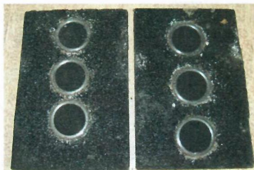
Рисунок. 1. Вид образца системы гидроизоляционного покрытия «Силор-Ультра» на металлическом основании со слоем из литой асфальтобетонной смеси ЛС тип V после отрыва элементов
