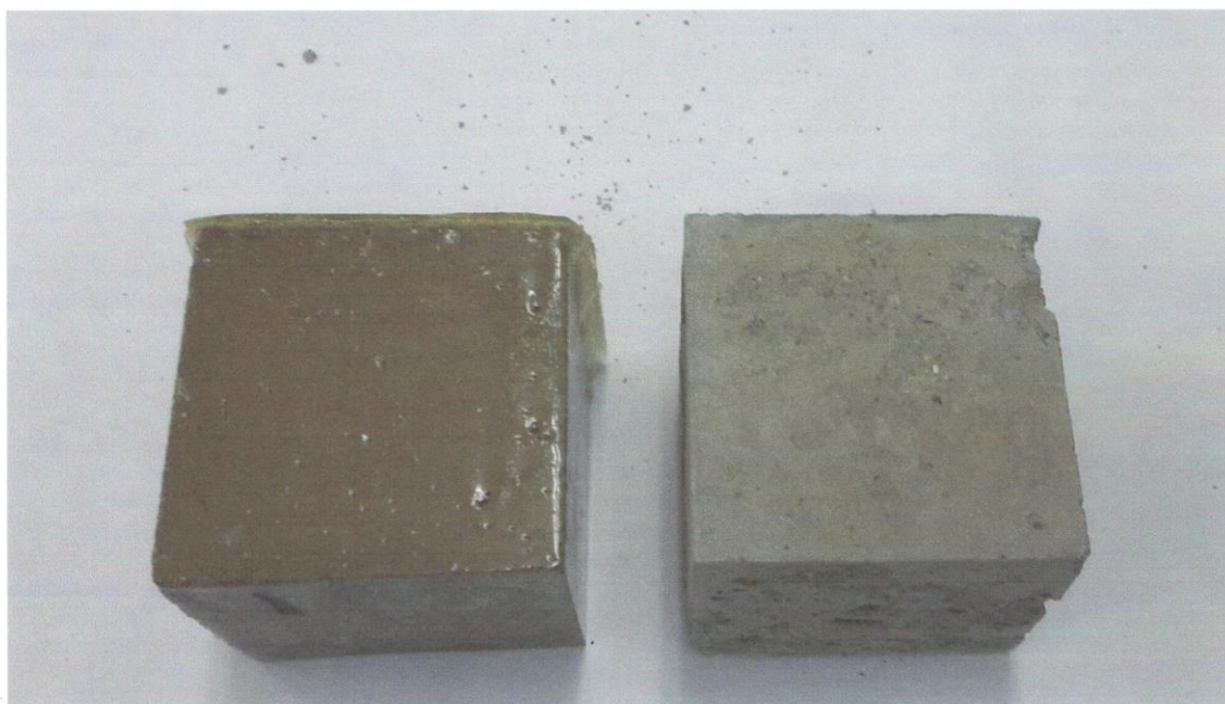
Рис. 6. Внешний вид образцов после 5 циклов испытаний на морозостойкость.
