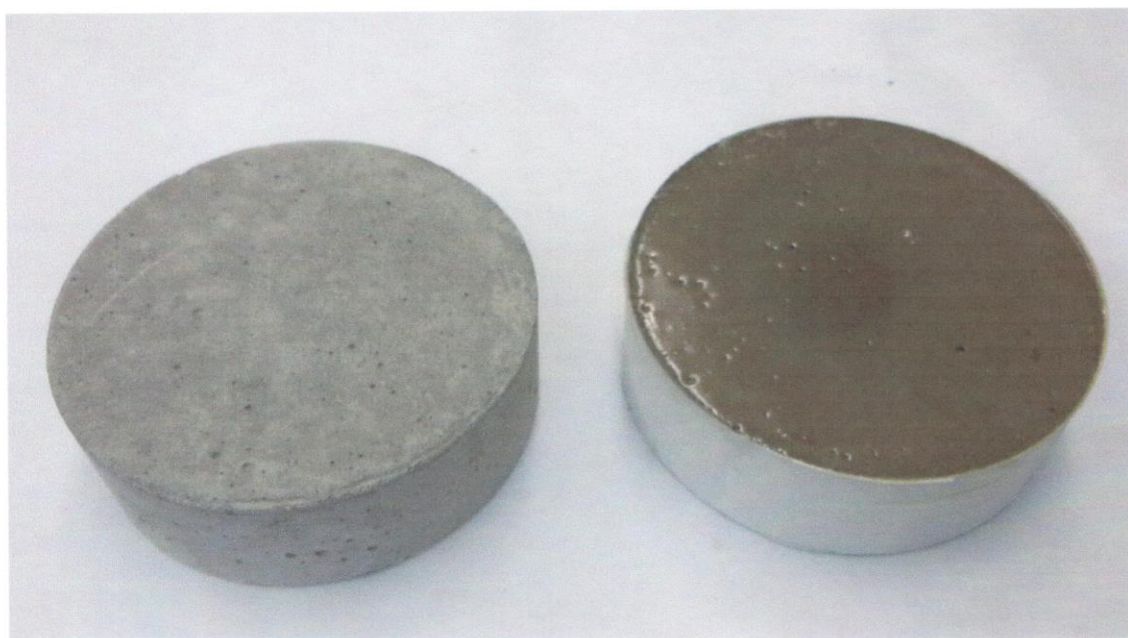
Рис. 3. Внешний вид образцов с системой гидроизоляционного покрытия Силор-Ультра и контрольных образцов для испытаний на водонепроницаемость.
