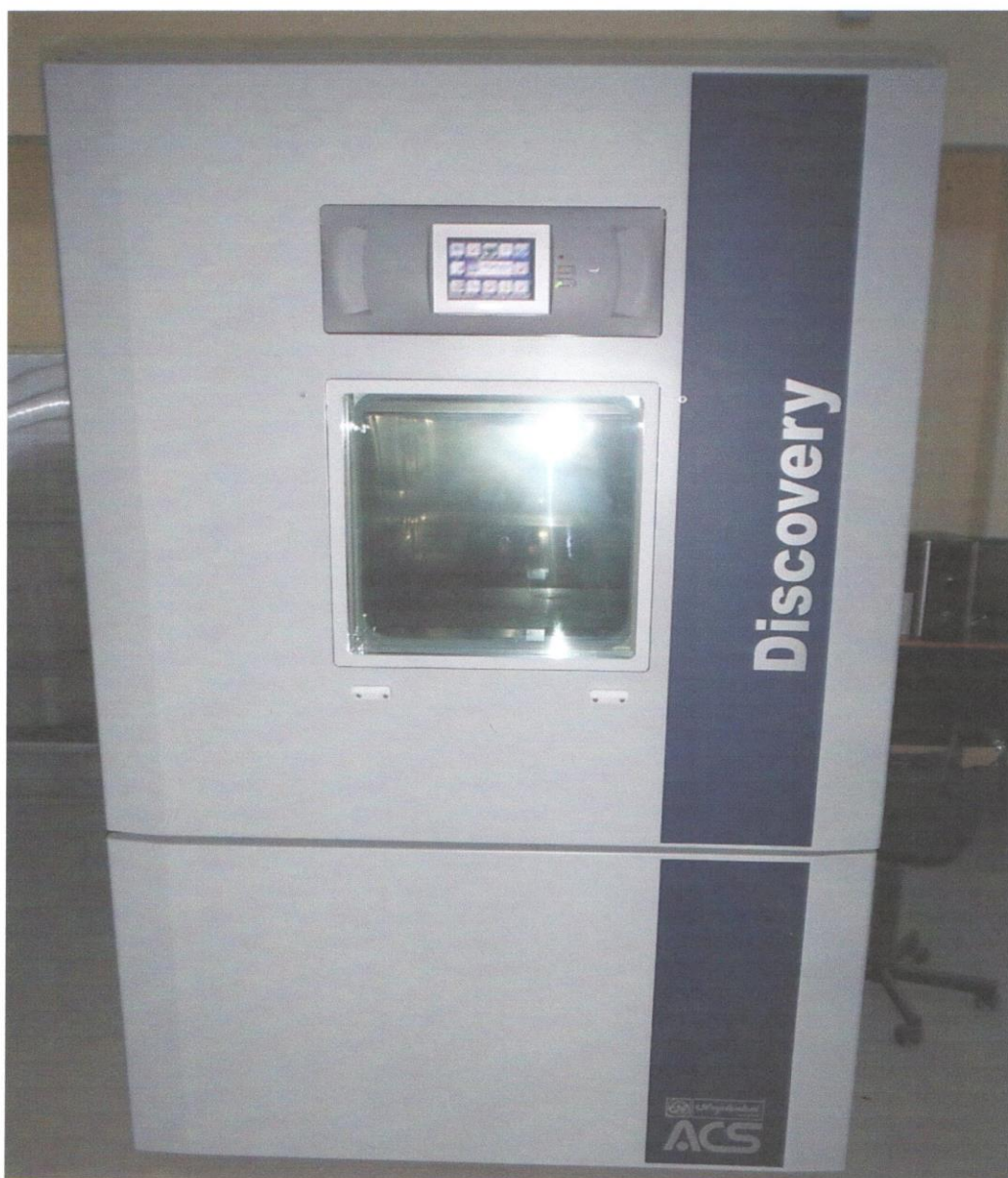
Рис. 4. Климатическая камера DV 1600С для испытаний на морозостойкость.
