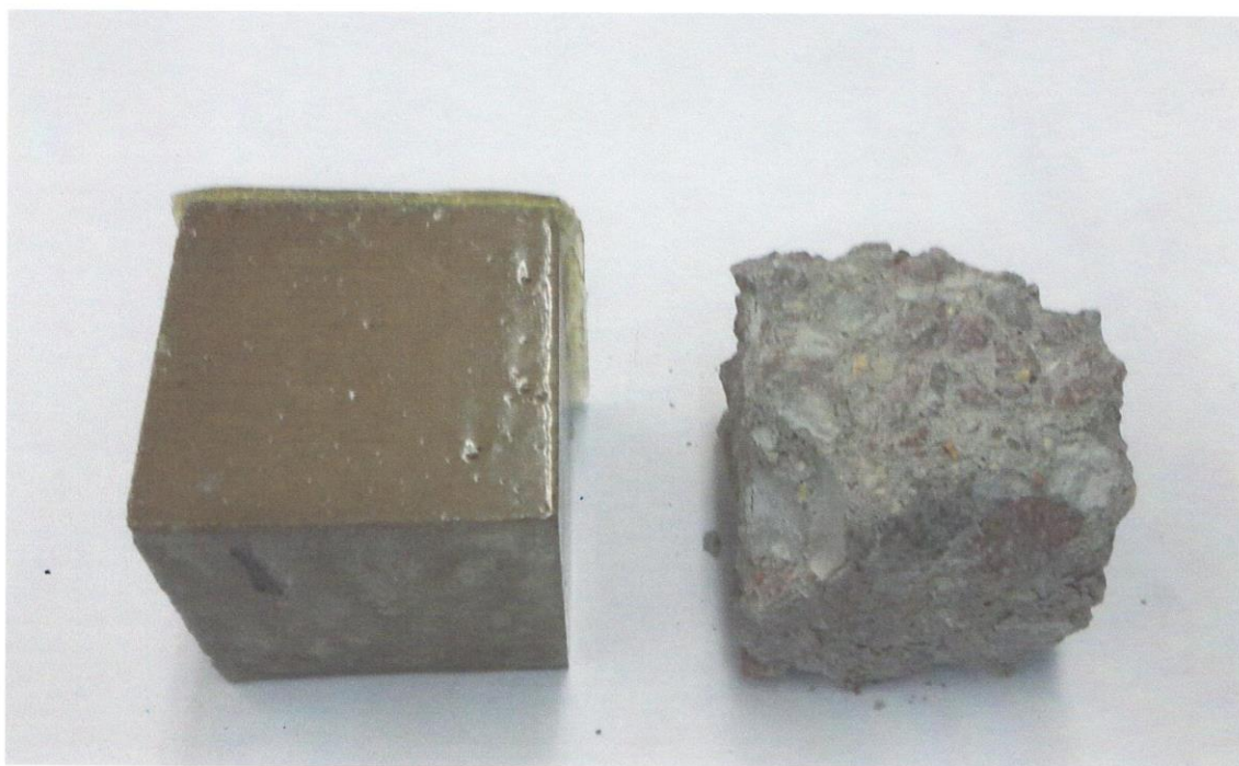
Рис.8. Внешний вид образцов после 15 циклов испытаний на морозостойкость.
